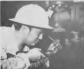
USANDO UN Penetron, J. Cross, senior engineering assistant den TSD, ta midi con diki e rand di un drum ta.
